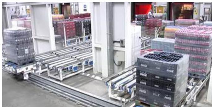
Con questo sistema sviluppato da System Logistics Rendelsur è stata in grado di concentrare la produzione, il magazzino e le attività di picking in un unico centro, continuare ad usare i distributori locali per le attività di picking e lo stoccaggio periferico servendo così i clienti dai distributori locali.
