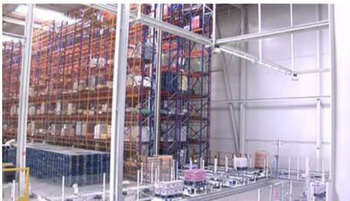
Steady Picking Location (SPL) con un buffer di 60 articoli in classe A gestito tramite veicoli SVL (system vehicle loop). L'area di picking consiste di sei baie di picking ed è servita da due trasloelevatori alti 14 metri che servono circa 2.500 posti pallet in un magazzino separato e dedicato esclusivamente alle operazioni di picking. Questo magazzino è servito da due veicoli SVL (System Vehicle Loop) per la gestione degli articoli ad alta rotazione.
